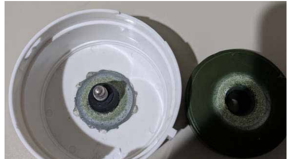
B. Condizione della girante rovinata per ASSENZA DI ACQUA
