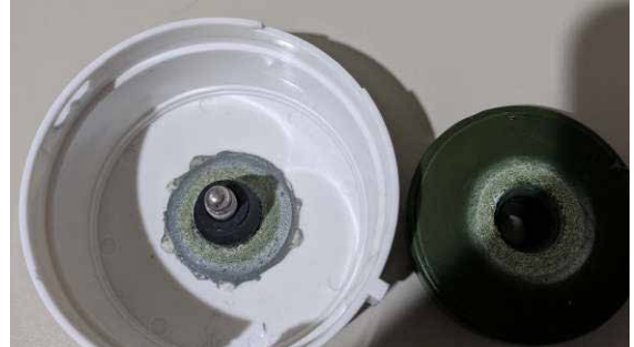
B. Condition du moteur en cas de fonctionnement sans d'eau
