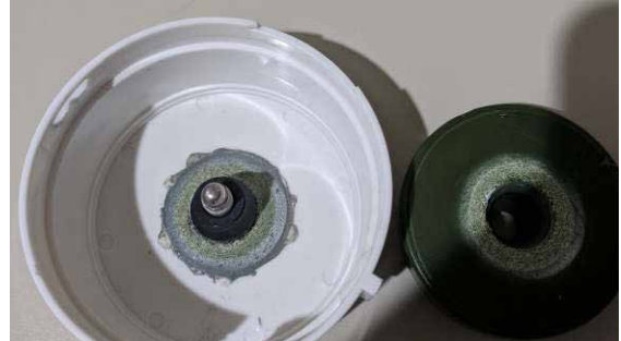
B. Zustand des Laufrads, das für das FEHLEN VON WASSER zerstört wurde
